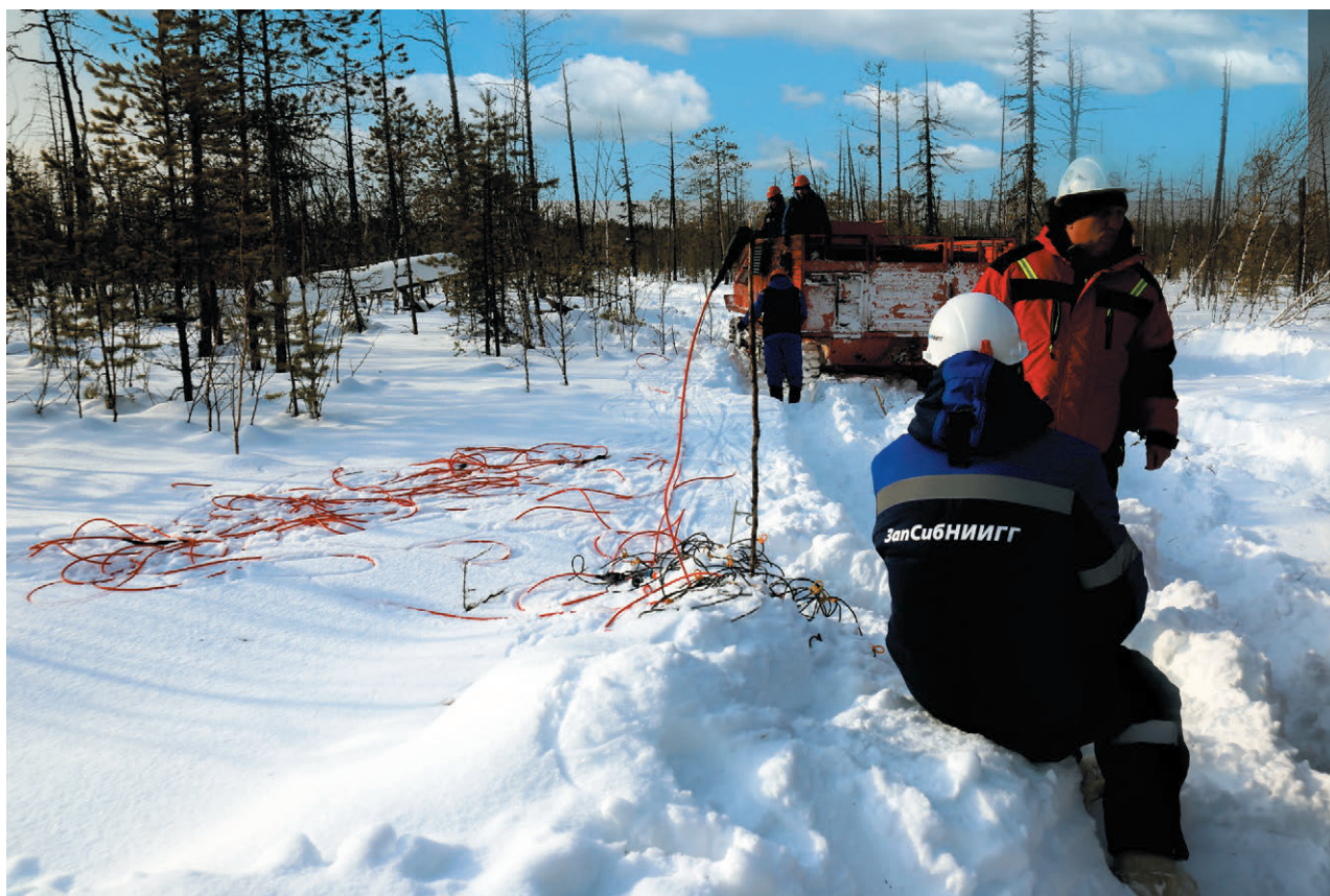
Рис. 7. Процесс размотки приемной линии во время проведения сейсморазведочных работ на Южно-Висимском участке Fig. 7. Unreeling a receiver line during seismic data acquisition at the South Visimsky site
