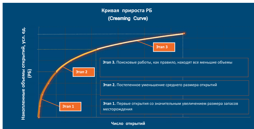
Рис. 5. Концепция численного описания кривой прироста РБ с диапазоном потенциала Fig. 5. The concept of numerical description of creaming curve with a range of potential
