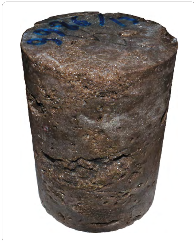
Рис. 2. Полноразмерный образец керна — модель пласта D_{5-2} Fig. 2. Whole core — model of D_{5-2} layer
