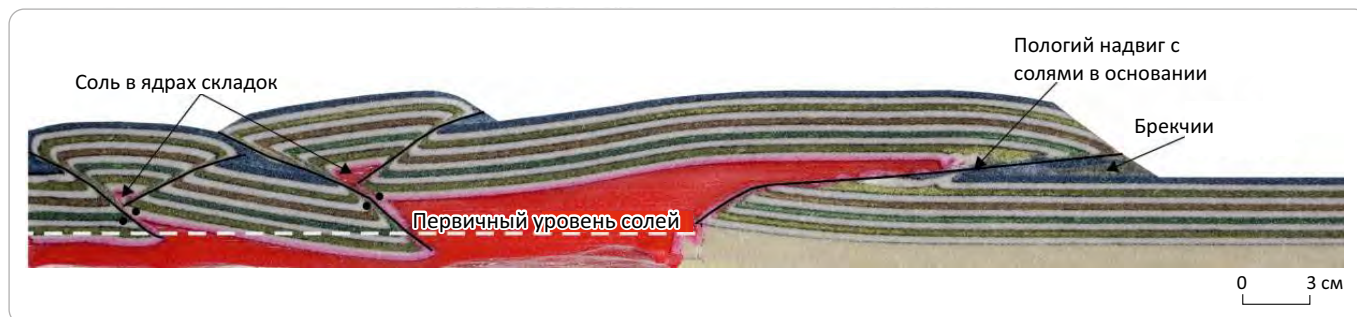
Рис. 7. Пример физического моделирования формирования на эквивалентных материалах процесса деформаций слоистой толщи с участием солей в условиях сжатия (по [11])
