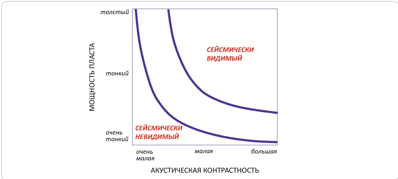
Табл. 1. Отличия в разрешающей способности при различных сейсмогеологических условиях [8]
