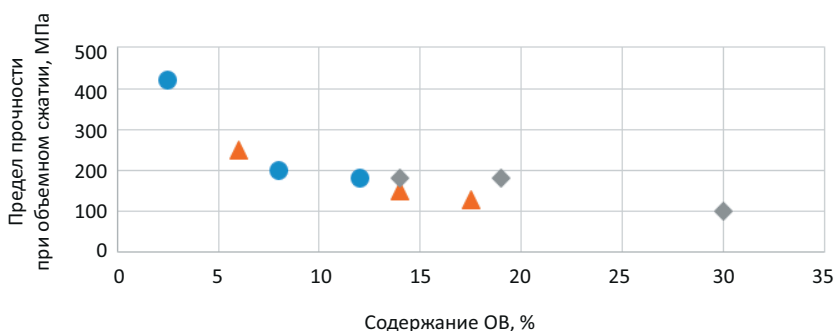
Рис. 5. Зависимость предела прочности горных пород при объемном сжатии от содержания ОВ
